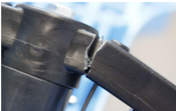
Abbildung 11: Bruch der Achse (TLV-Bildaufnahme)
