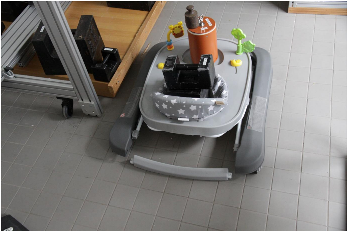
Abbildung 16: Lauflernhilfe bestand die statische Festigkeitsprüfung nicht (TLV-Bildaufnahme)
